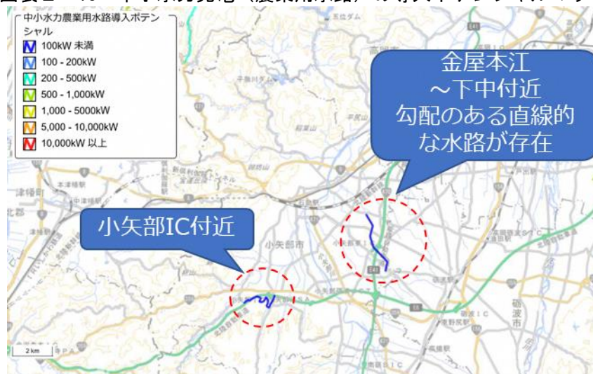
図表 2-13 中小水力発電（農業用水路）の導入ポテンシャルマップ
