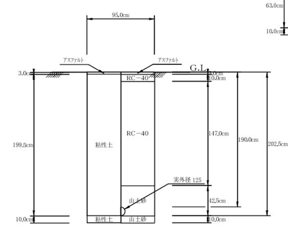
00:配水管 04:HPPEφ100H=1000(B) 下水同時 (掘削・埋戻し) 1/25
