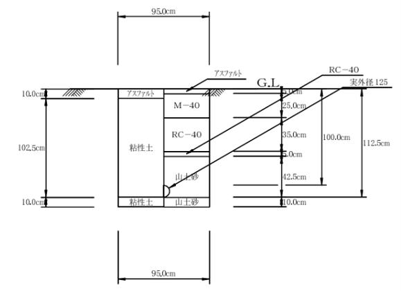
00:配水管 05:HPPEφ50H=600(歩道) 下水同時 (掘削・埋戻し) 1/25
