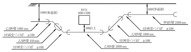
00:配水管 03:HPPEφ100H=600(歩道) 下水同時 (掘削・埋戻し) 1/25
