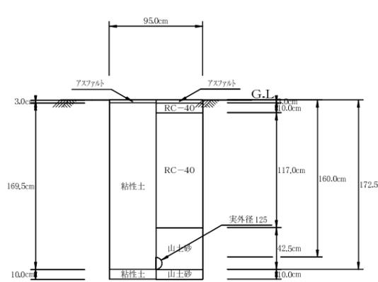
00:配水管 02:HPPEφ100H=1900(歩道) 下水同時 (掘削・埋戻し) 1/25
