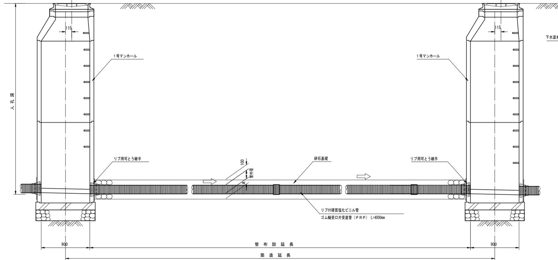
リブ付硬質塩化ビニル管寸法図
