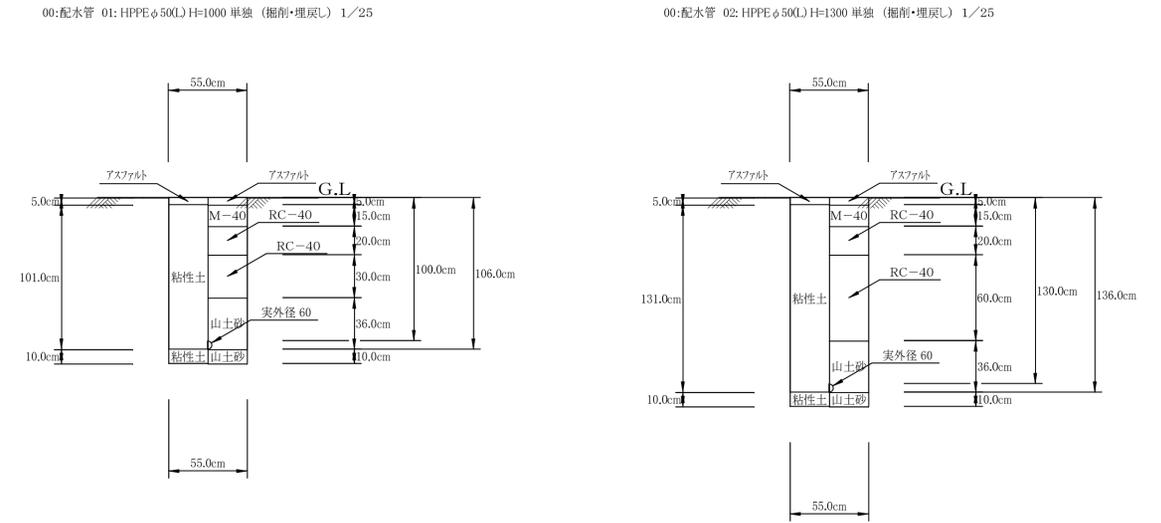
00:配水管 03: HPPE φ50(L) H=1000 下水同時 (掘削・埋戻し) 1/25
