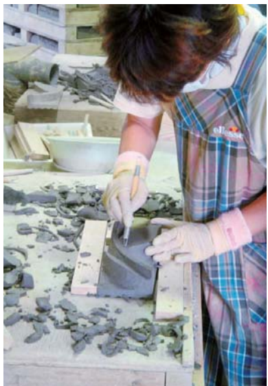
武蔵野野小学校の巨大壁面タイルレリーフ(浮き彫り細工)。1枚毎に専用の治具を用いて削り出す。
