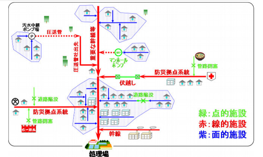
図5 点的施設・線的施設・面的施設のイメージ図
