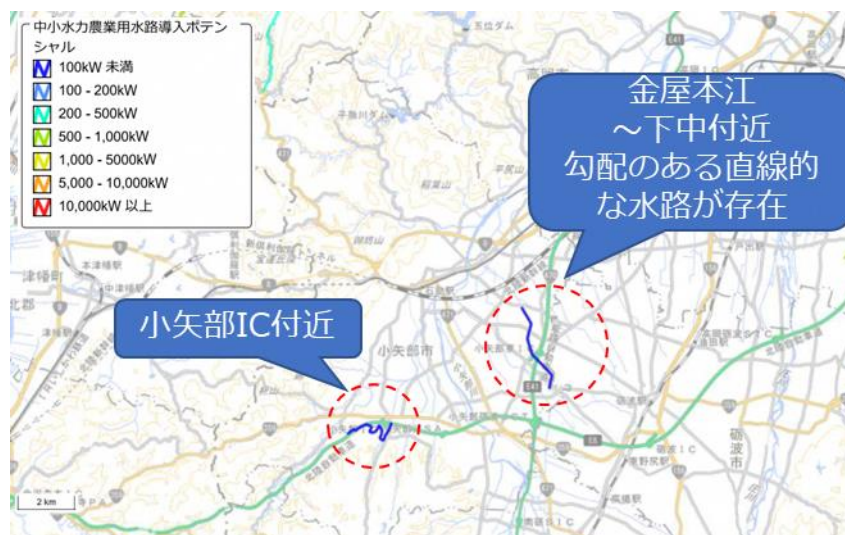
図表 4-55 中小水力農業用水路への導入ポテンシャルマップ
