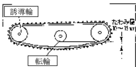
5. 調整後、ロックナットを締付けます。
