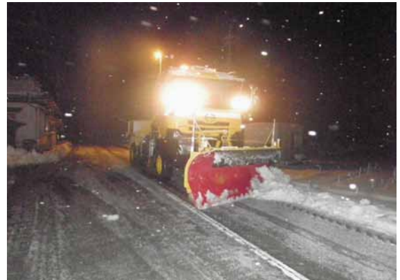
除雪車による除雪作業
